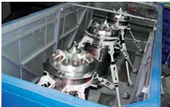
Рис. 9 – Транспортный пакет для перевозки ОЯТ ИР
