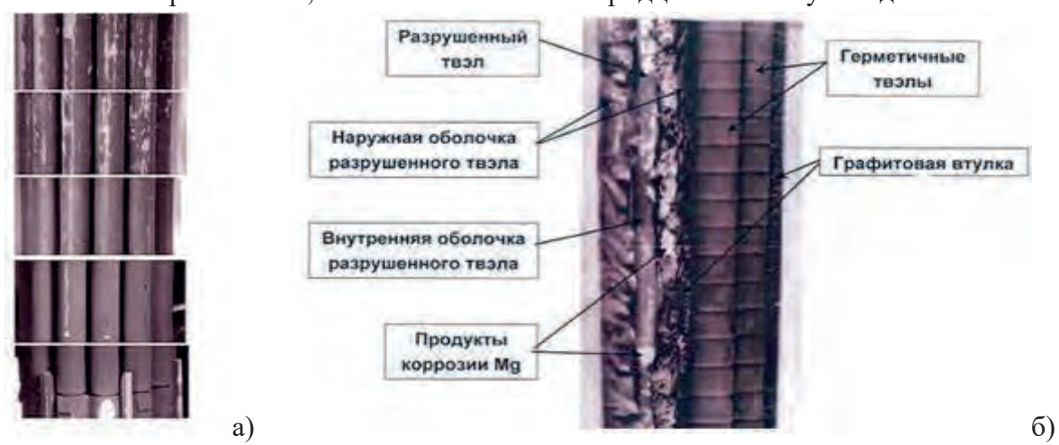
Рис. 3 – Коррозионные повреждения топлива РБМК (а) и аварийная ОТВС (б)
