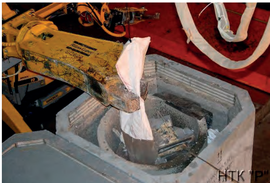
Рис. 5 – Фрагментация высокоактивных бериллиевых блоков с загрузкой в контейнеры НЗК-150-1.5П
