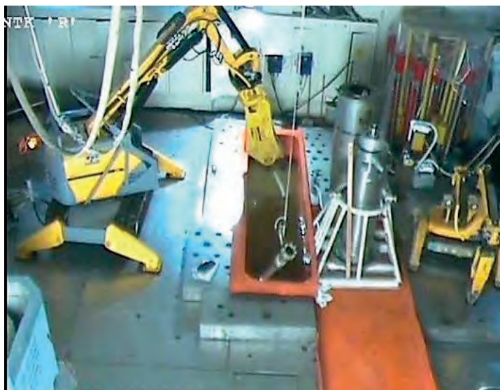
Рис. 4 – Процесс резки циркониевых каналов под водой
